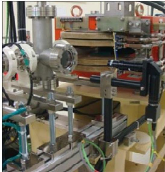
Figura 1: Desenho esquemático de um monitor de perfil não refrigerado com atuador pneumático e foto de um monitor de perfil de um acelerador de Taiwan.
