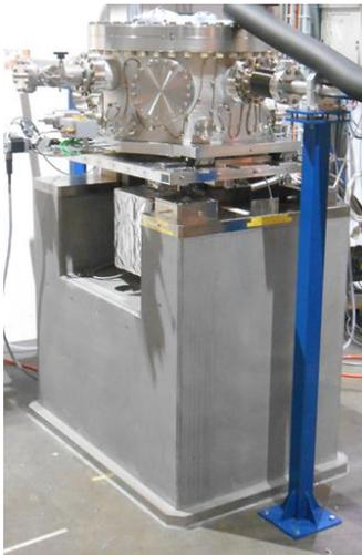
Fig. 2: Suporte para câmara na linha de luz de NanoXAS do SLS (Villigen, Suíça).
