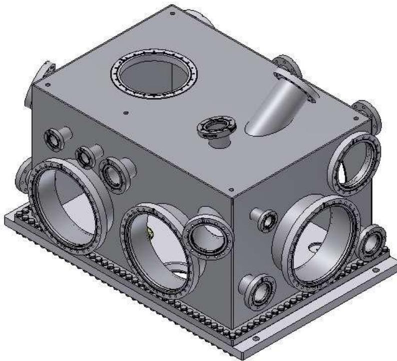
Figura 3 - Câmara para monocromador formato retangular.
