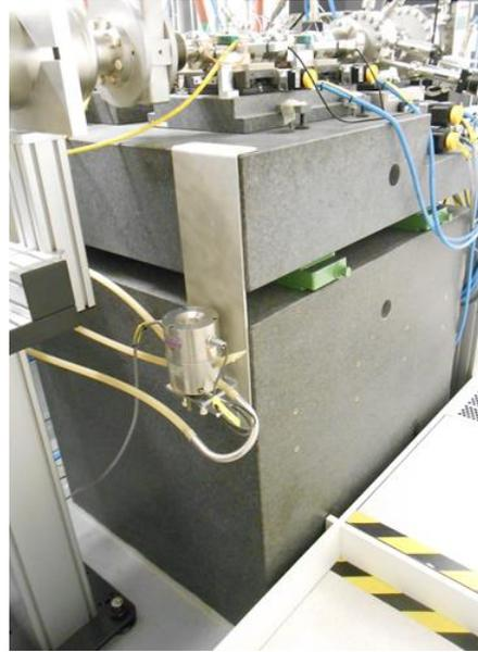
Fig. 1: Monocromador (esquerda) e suporte para máscaras e BPMs (direita) na linha de luz ID16 do ESRF (Grenoble, França).
