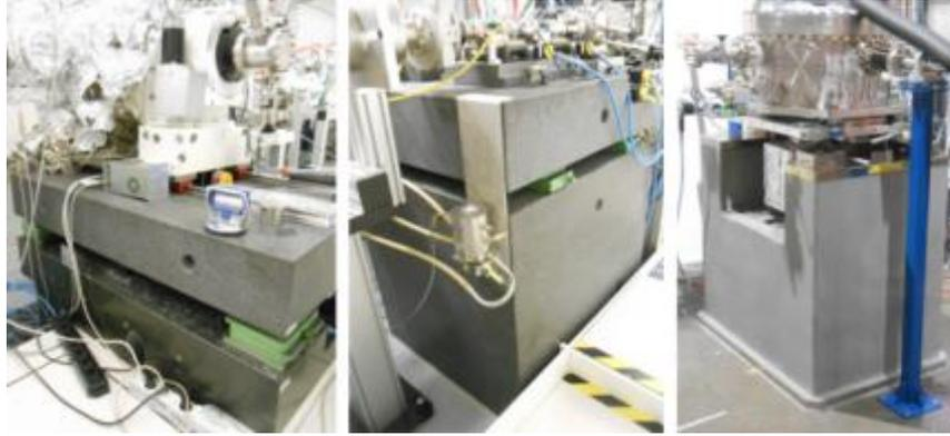
Figura 2: Componentes ópticos na linha de luz ID16 do ESRF na França: monocromador (esquerda) e suporte para máscaras e BPM's (centro). Na linha de luz NanoXAS do SLS na Suíça, à direita.
