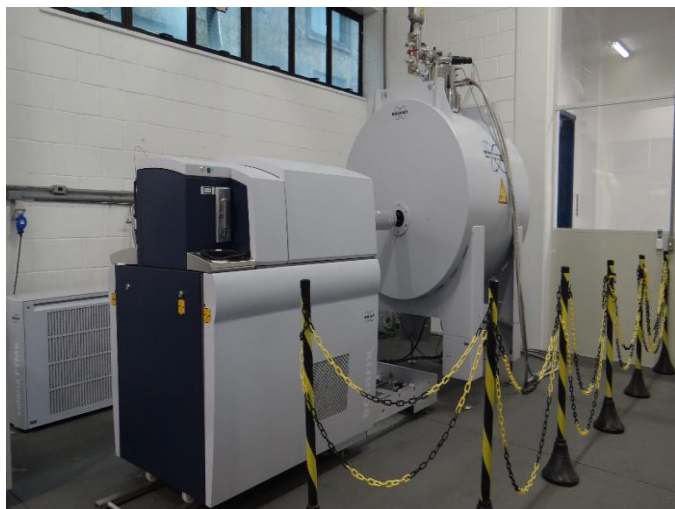
Espectrômetro de massas de alta resolução e exatidão com Transformador de Fourier (FT/MS)
