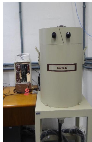
Espectrômetro Gama com detector germânio de alta resolução
