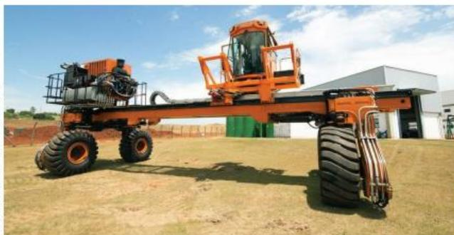
**Figura 84: Estrutura de Tráfego Controlado (ETC).**
