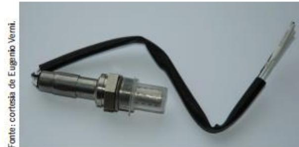
Figura 76: Sonda lambda Magneti Marelli.
