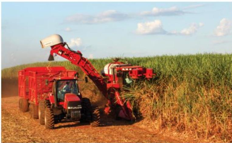
Figura 49: Colheita mecanizada de cana-de-açúcar, sem queima.
